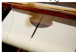
Рисунок 1 – Создание формы горловины во время ткачества.
