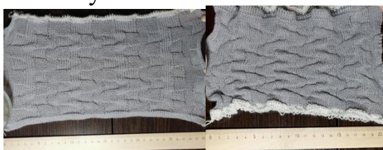
Рисунок 4 – Растяжение образцов с глубиной кулирования 400 и 280 соответственно
