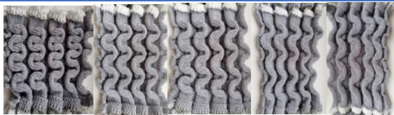
Рисунок 3 – Образцы двухизнаночной глади с h_k 280, 300, 320, 350, 400 соответственно
