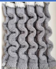
Рисунок 2 – Образец трикотажного полотна переплетения двухизнаночная гладь
